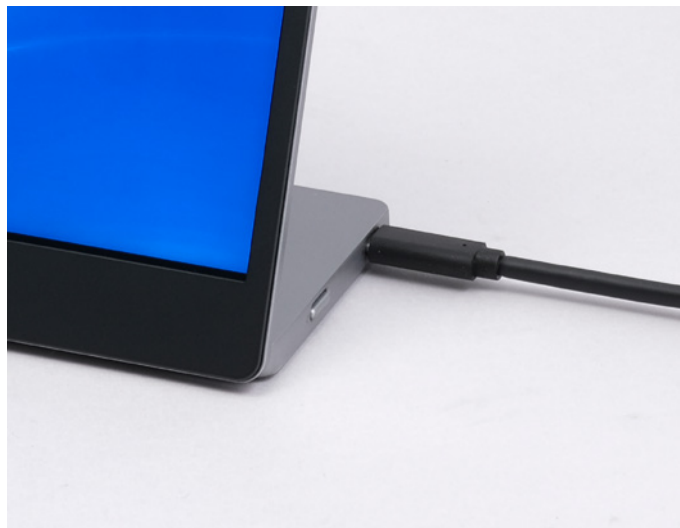
モバイルPCとはUSB Type-Cケーブルを1本接続するだけで電源と映像信号を供給できる。USB Type-C端子を左右の両側面に用意しているのもポイントだ
